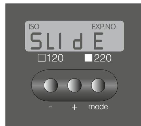
Im LC-Display an der Rückwand des Magazins werden die wichtigsten Funktionen und Betriebszustände des Magazins angezeigt.
